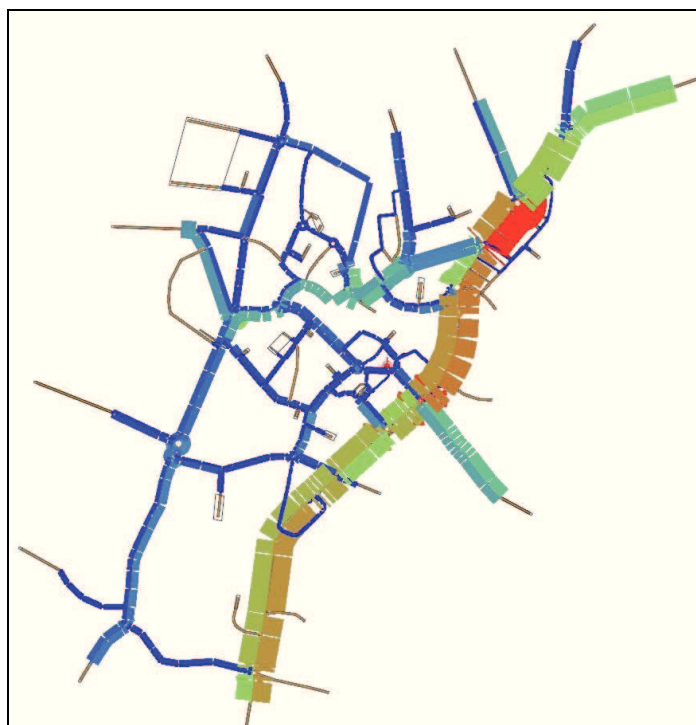
Flussogramma relativo allo stato di fatto nell'orario 18:00 – 19:00 (flussi crescenti da blu a verde a marron a rosso)
